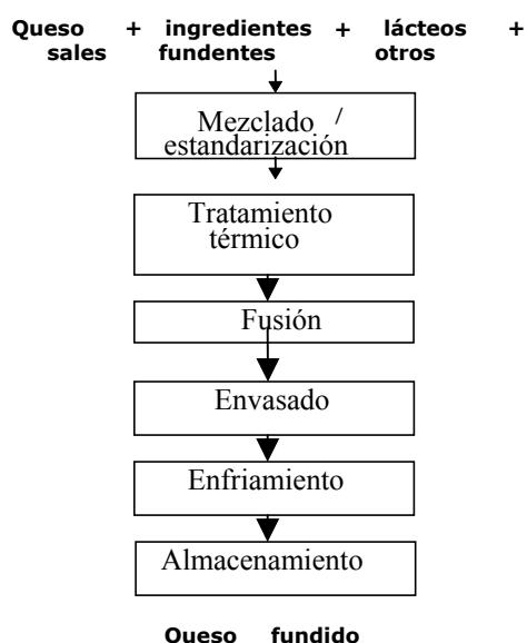
Figura 15. Diagrama de flujo de elaboración de queso fundido
